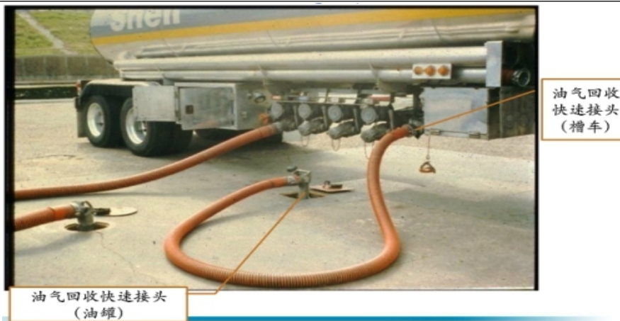
图 5-3 一次油气回收实例图
